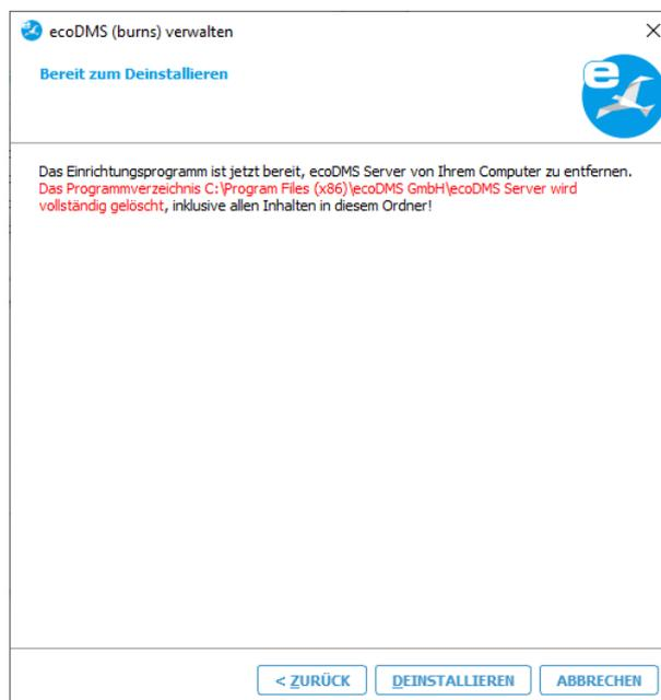
Abb. (ähnlich) 2.37: ecoDMS Server deinstallieren - Datenbestand löschen
